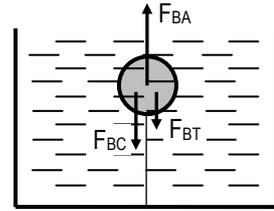
A05 Una bola de acero que cuelga de un cordel se introduce en un depósito lleno de agua y se fija su posición tal como indica la figura. Especificar las fuerzas que se ejercen sobre la bola y dibujarlas con claridad.
