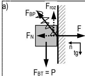
A la vista del diagrama de fuerzas, deslizará si  $P = 22,2 > F_{roz \text{ máx}} = \mu_e F_N$ .
