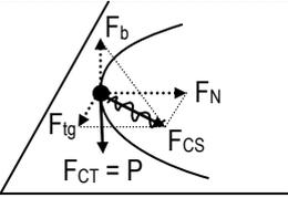
Sobre el coche actúan dos fuerzas: la que ejerce la Tierra y la que ejerce el suelo. Utilizamos coordenadas intrínsecas espaciales, formados por las direcciones normal, tangente y binormal. Suponemos, por simplicidad, que el coche va a velocidad constante. Luego  $a_{tg} = 0$ .
